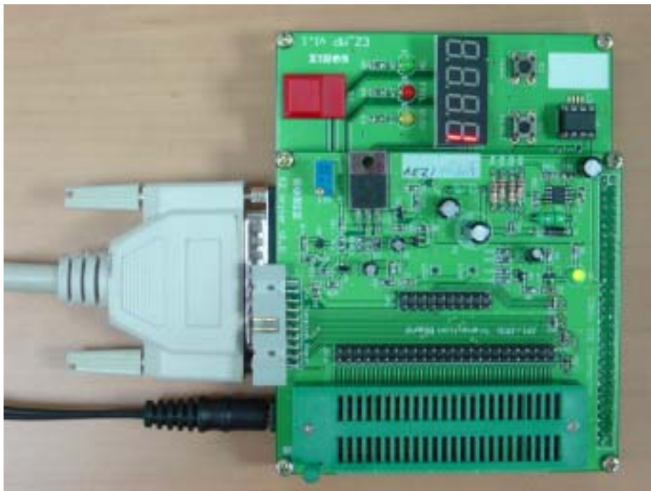
圖片 6 下載 EEPROM 時的硬體安裝
