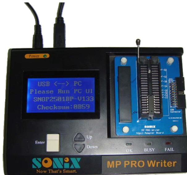
图 2-1 MP PRO Writer 硬件连接后示意图
