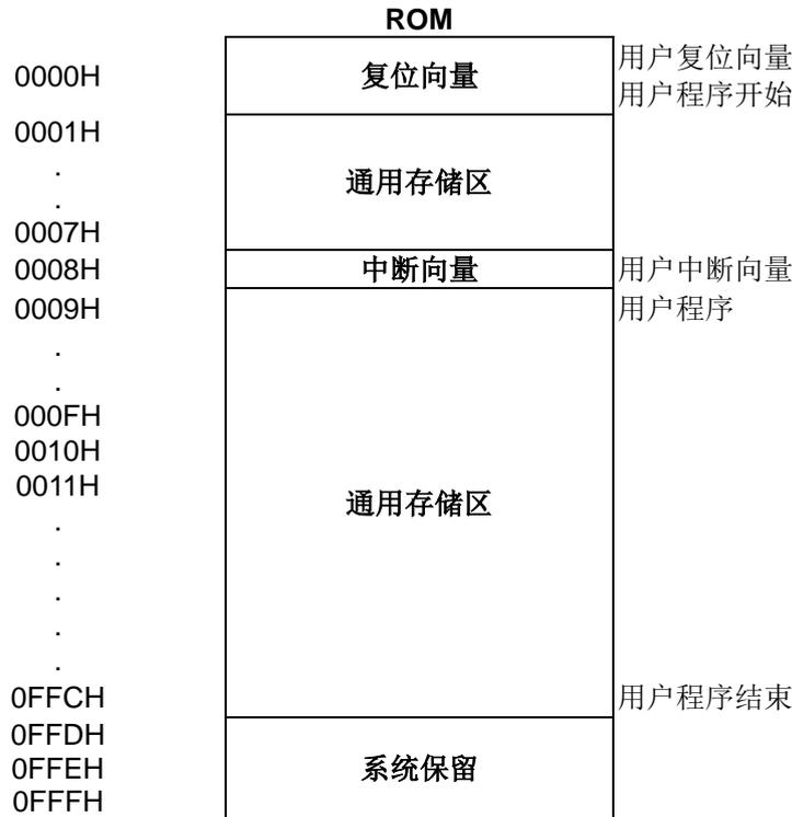
ROM 包含复位向量、中断向量、通用存储区域和系统保留部分。复位向量是程序的开始位置，中断向量则是中断服务程序的开始位置，而通用存储区域则保存主程序、子程序及数据表格。
